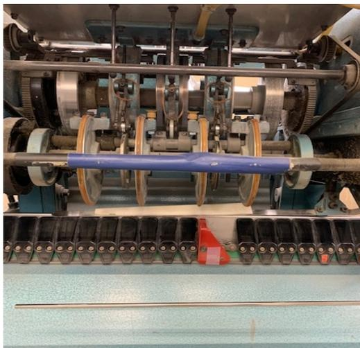
中綴じ機械の多くは**右から左へと機械のレールが刷り本を運んでいます** 図の要領で紙を折ってみると小口側になる後半の余白(袋部分)が前半のそれよりも長くなっていることがわかります。この部分を「ラップ」と呼び、中綴じ機械の台座に置いてある**刷り本を1部づつ機械が掴まんで流れているレールの上に置いていく役割が有ります**。この時刷り本は**小口を下に、天側は右に向いた状態になり** レールに設置してある**赤い部品**によって綴じ部分へ送られるのと同時に、位置揃えを行い罫線や絵柄がきちんとそろう仕組みです。印刷で例えると「針」の役割です。では斜線部分が6ミリ(3・3)ならばどうでしょう？この場合小口側の前半ページ部分の余白が長くなります。**小口は下ですが 天側は左に向いた状態になりますつまり針ではない部分で絵柄や**
